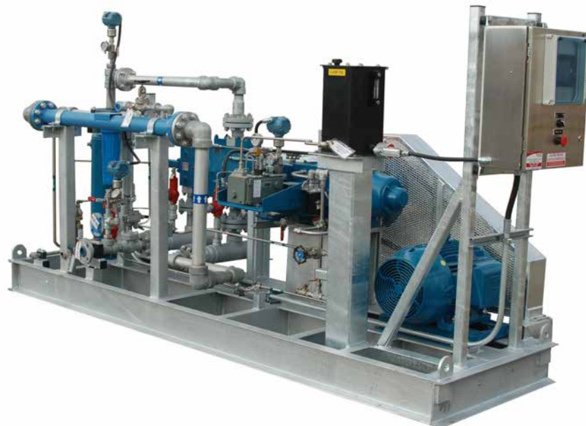
Unidad de recompresión de nitrógeno.
